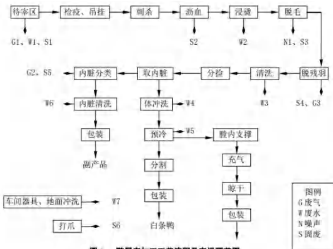
图6 鸭屠宰加工工艺流程及产污环节图
