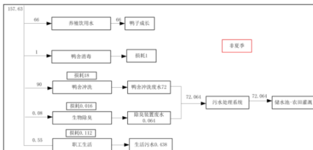
图 3.5-2 项目（非夏季-产污最严重1天）工程水平衡图 单位：m 3
